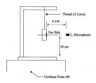
0.1 METER FROM MICROPHONE TO FAN INTAKE
