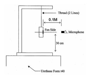
0.1 METER FROM MICROPHONE TO FAN INTAKE
