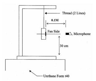
0.1 METER FROM MICROPHONE TO FAN INTAKE
