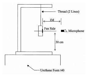
1 METER FROM MICROPHONE TO FAN INTAKE
