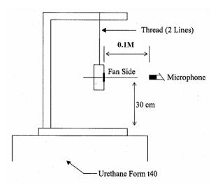
0.1 METER FROM MICROPHONE TO FAN INTAKE
