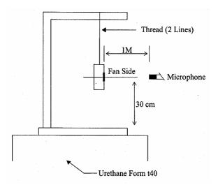
1 METER FROM MICROPHONE TO FAN INTAKE
