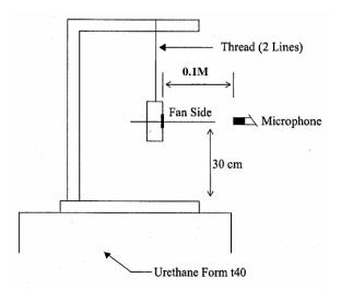
0.1 METER FROM MICROPHONE TO FAN INTAKE
