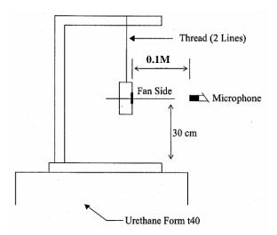
0.1 METER FROM MICROPHONE TO FAN INTAKE
