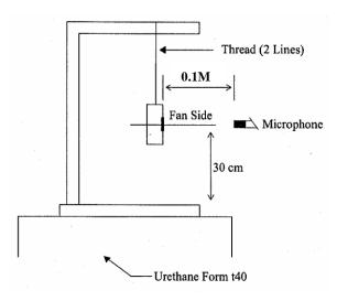
0.1 METER FROM MICROPHONE TO FAN INTAKE
