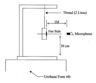
1 METER FROM MICROPHONE TO FAN INTAKE
