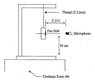
0.1 METER FROM MICROPHONE TO FAN INTAKE
