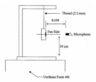
0.1 METER FROM MICROPHONE TO FAN INTAKE
