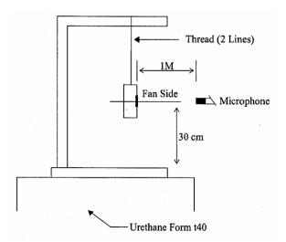
1 METER FROM MICROPHONE TO FAN INTAKE
