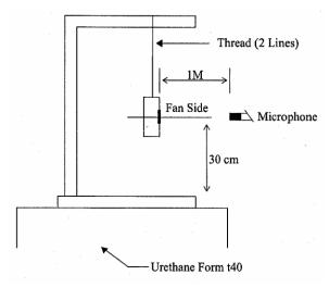
1 METER FROM MICROPHONE TO FAN INTAKE
