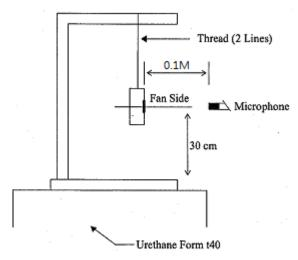
0.1 METER FROM MICROPHONE TO FAN INTAKE
