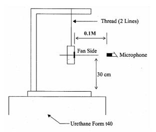
0.1 METER FROM MICROPHONE TO FAN INTAKE
