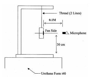
0.1 METER FROM MICROPHONE TO FAN INTAKE
