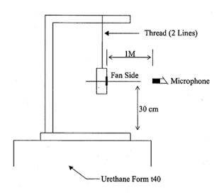
1 METER FROM MICROPHONE TO FAN INTAKE
