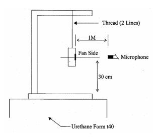
1 METER FROM MICROPHONE TO FAN INTAKE
