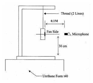
0.1 METER FROM MICROPHONE TO FAN INTAKE
