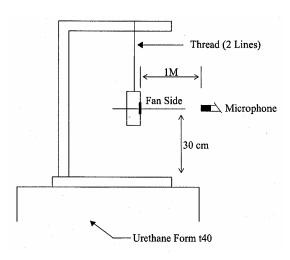
1 METER FROM MICROPHONE TO FAN INTAKE
