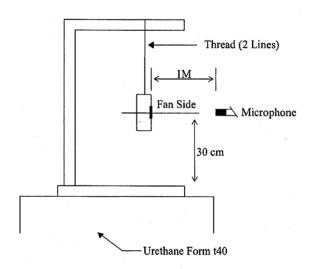
1 METER FROM MICROPHONE TO FAN INTAKE
