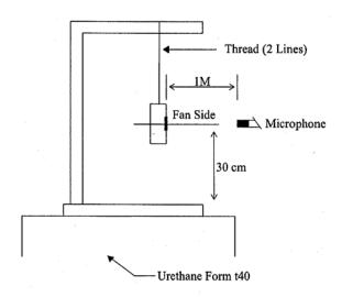
1 METER FROM MICROPHONE TO FAN INTAKE
