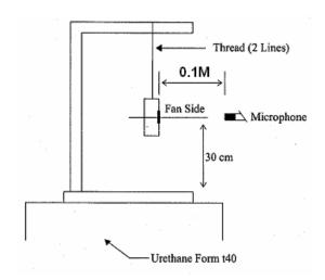
0.1 METER FROM MICROPHONE TO FAN INTAKE
