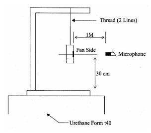
1 METER FROM MICROPHONE TO FAN INTAKE
